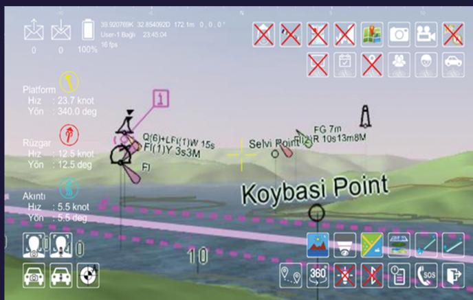
AnyView360, zırhlı araçların atış kontrol sistemindeki görüntüleme sistemlerinden, İHA ve diğer görüntü kaynaklarından alınacak görüntülerin artırılmış gerçeklik gözlük ekranında birlikte görüntülenmesini ve harici sistemler ile görüntü alışverişi yapılmasını da sağlar.
